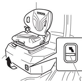
(1) Variklio gaubto fiksuatoriaus atlaisvinimo svirtis
