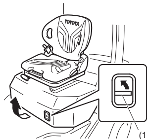
(1) Dzinēja pārsega atbloķēšanas svira
